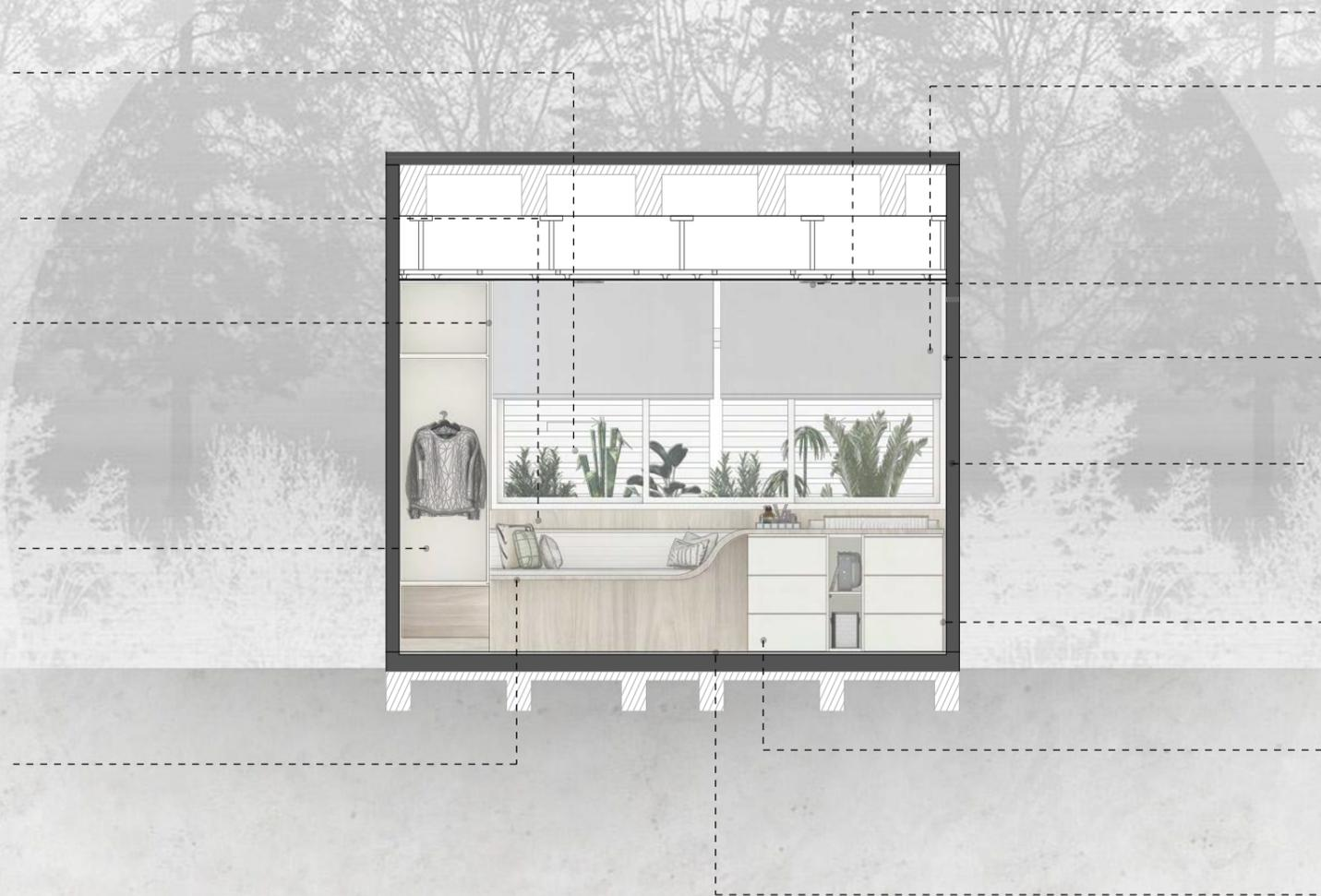
Cielorraso suspendido placas de roca de yeso tipo CIEL Durlock de 7 mm. de espesor - ancho 1,2 mts. largo 2,4mts.
