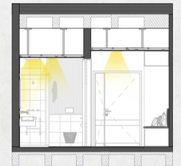
Cielorraso suspendido placas de roca de yeso CIEL Durlock de 7 mm. de espesor - ancho 1,2 mts. largo 2,4mts.
