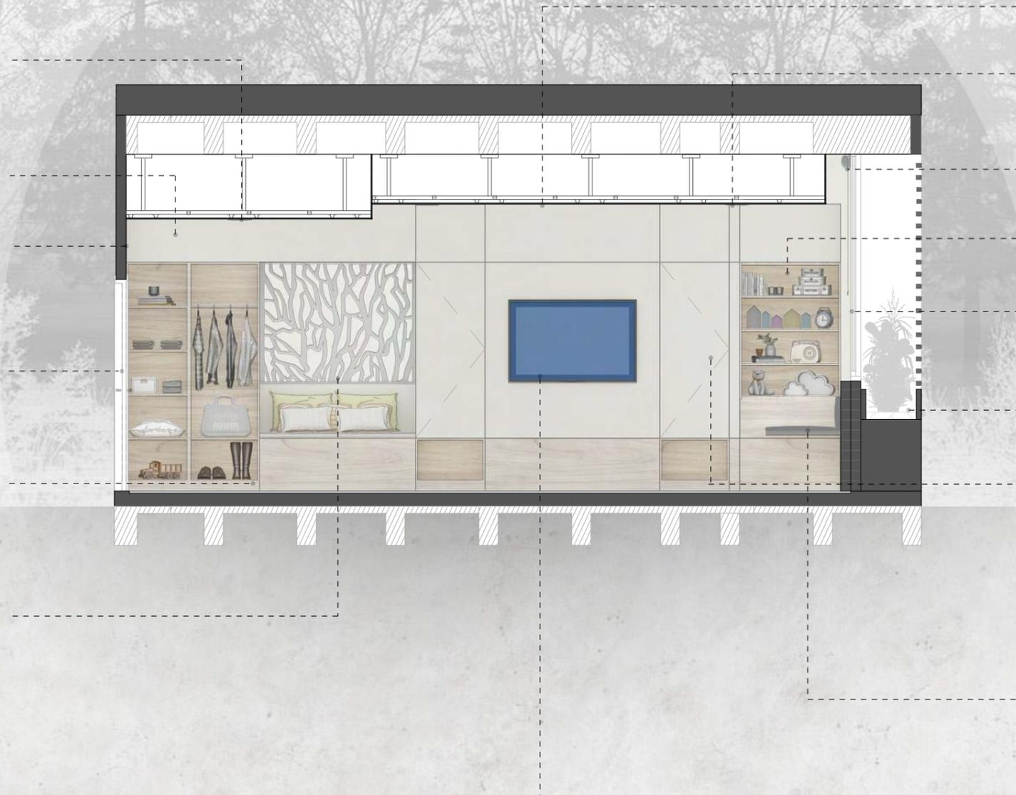
Cielorraso suspendido placas de roca de yeso CIEL Durlock de 7 mm. de espesor - ancho 1,2 mts. largo 2,4 mts.
