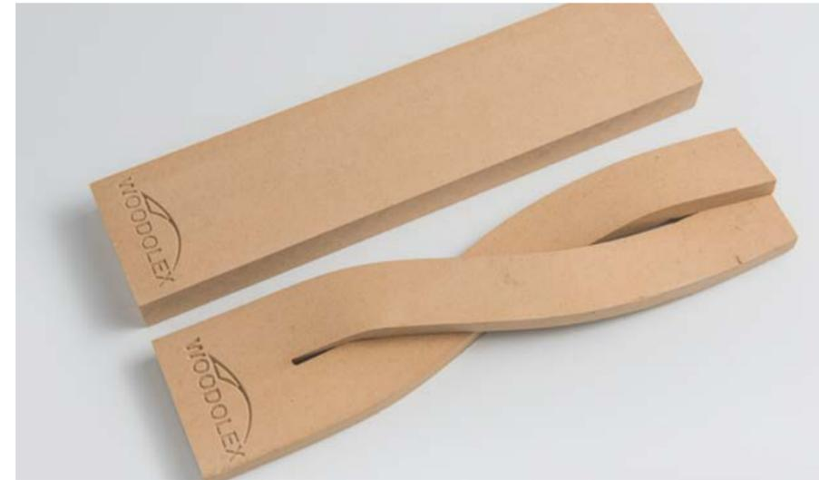
**Composición:** Tableros de madera flexibles fabricados con un **96 % de madera reciclada** y un 4 % de adhesivo.
