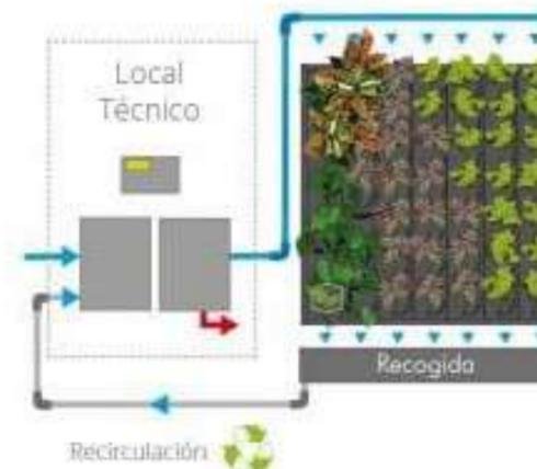
Este esquema está indicado para superficies grandes a muy grandes de jardín vertical (>90 m<sup>2</sup>). En este esquema se recupera el excedente de agua de riego en un circuito cerrado, conectándose a depósitos, donde una vez tratada el agua vuelve a utilizarse para el riego del muro verde. Precisa de acometidas básicas en local técnico para instalaciones auxiliares, depósitos y control avanzado.
