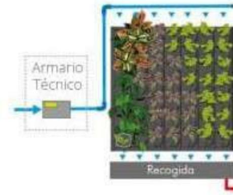
Este esquema está indicado para superficies pequeñas y medianas de jardín vertical (hasta 85-90 m<sup>2</sup>). En este esquema no se recupera el excedente de agua de riego, conectándose a desagüe directamente. Precisa de acometidas básicas en armario técnico para instalaciones auxiliares.
