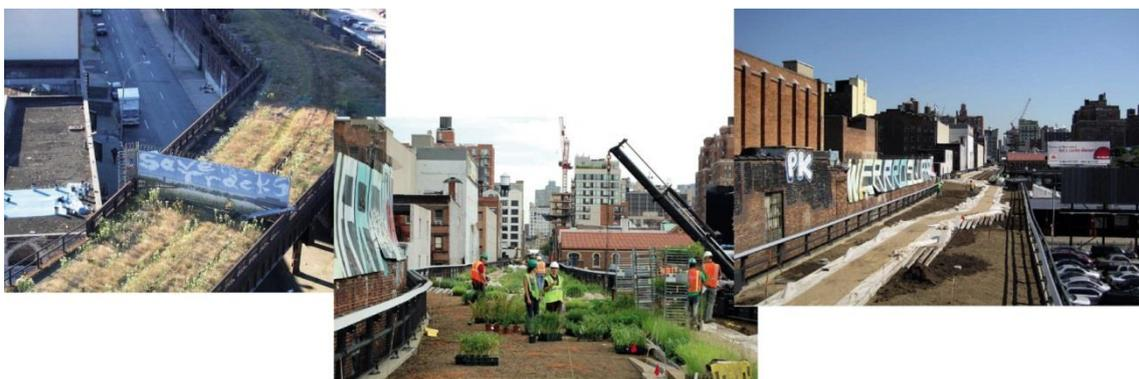
Los paseos del parque creados a partir de unas planchas lisas y cónicas de cemento se colocaron encima de la capa de hormigón impermeabilizado, dejando entre ellos espacios para los conductos eléctricos y el drenaje. Construcciones de escaleras y ascensores permiten a los visitantes acceder desde el nivel de la calle. También cuenta con accesos para sillas de ruedas en los puntos de acceso donde no hay ascensor.
