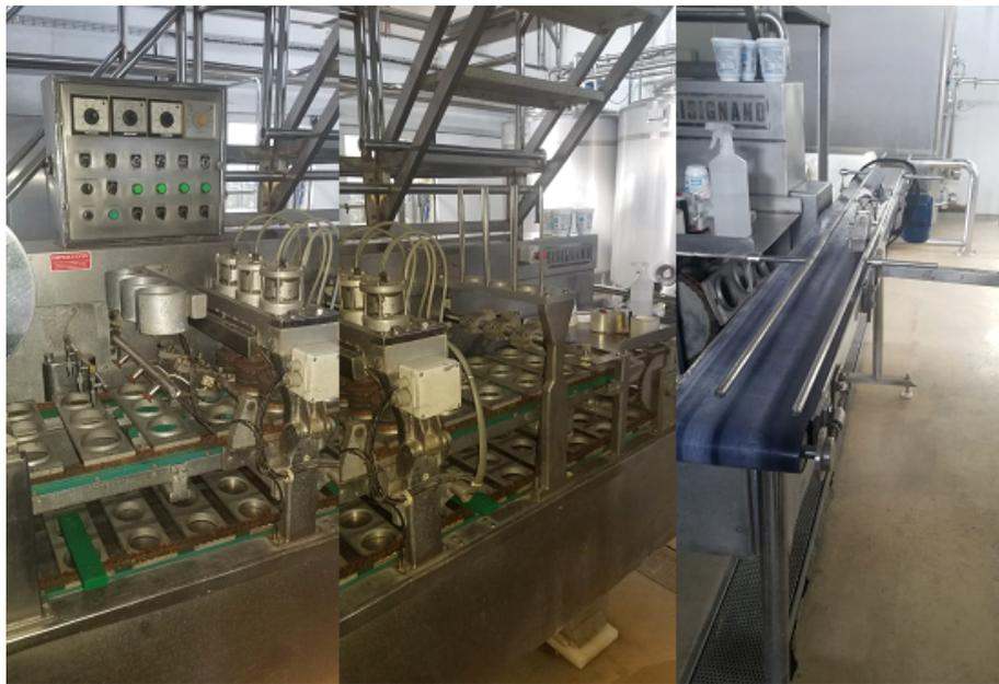
Imagen 5: Envasadora y etiquetadora
