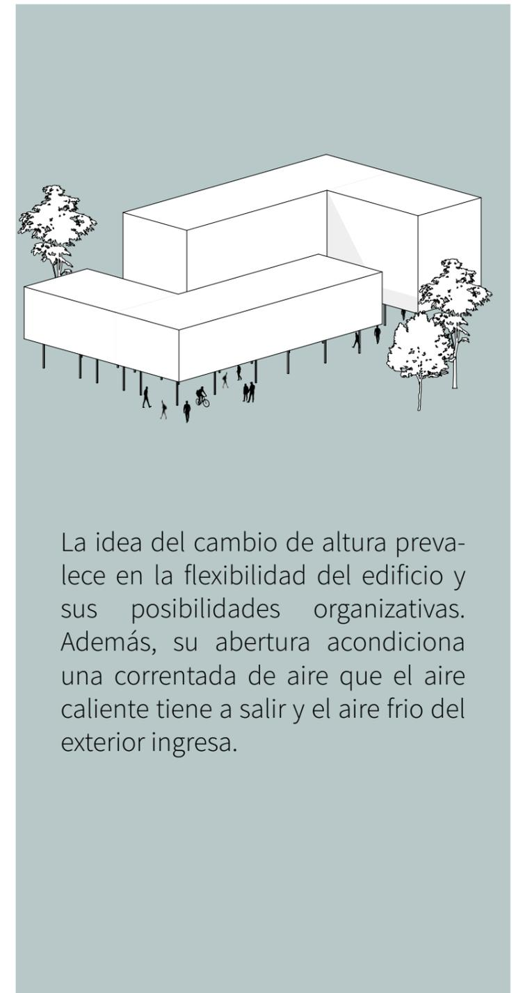
La idea del cambio de altura prevalece en la flexibilidad del edificio y sus posibilidades organizativas. Además, su abertura acondiciona una corriente de aire que el aire caliente tiene a salir y el aire frío del exterior ingresa.
