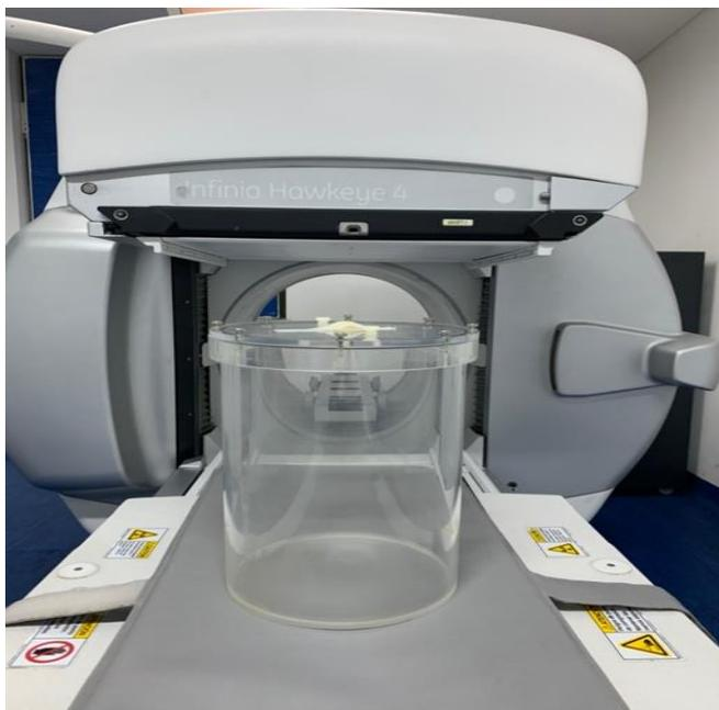
**Figura 8.** Fantoma cilíndrico en una cámara gamma SPECT-CT.
